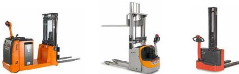
Gerbeur à contrepoids / Bras de fourche recouvrant / Mât central
