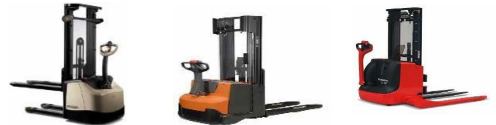
Double fourche / Mât télescopique double(ou triple) / Double fourche
